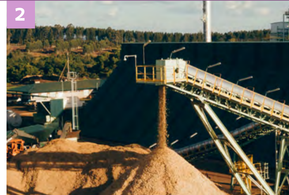
2 Recepción y chipeo. Reduce el tamaño de los chips para almacenar en el silo.
